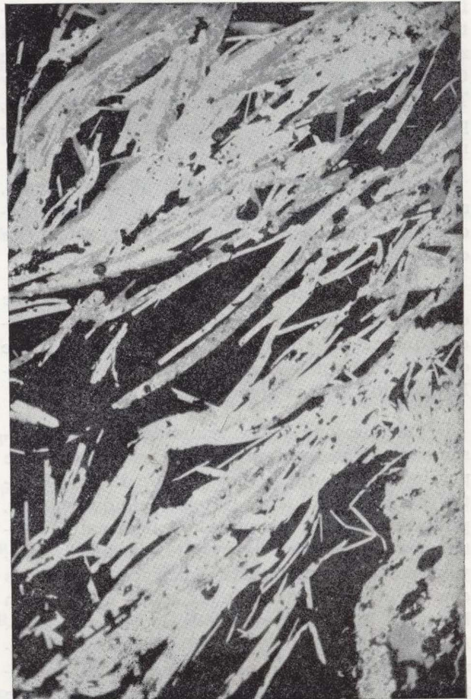
Foto 5.—Cristales de hematites en proceso de magnetización (luz reflejada, aceite, \times 350 , N II).
