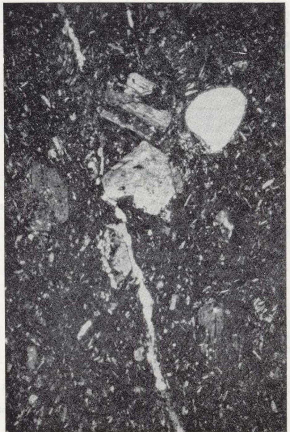
Foto 2.—Fenocristales de plagioclasa y cuarzo en lava dacítica inferior (luz transmitida, ×36, N X).
